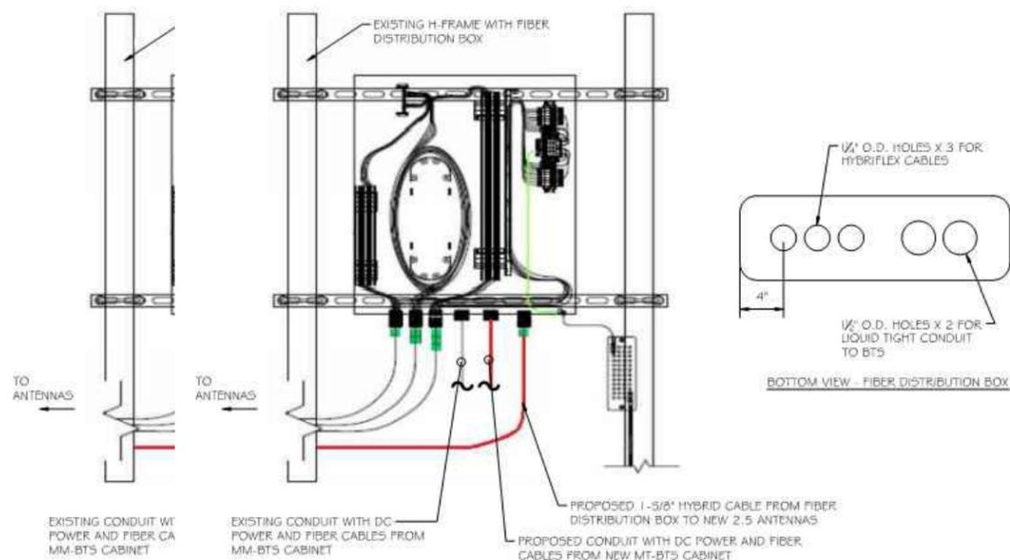
BTS TO DISTRIBUTION BOX FIBER CONNECTIVITY DETAIL
